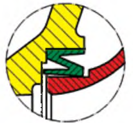
Кольцо износа в ходе эксплуатации
