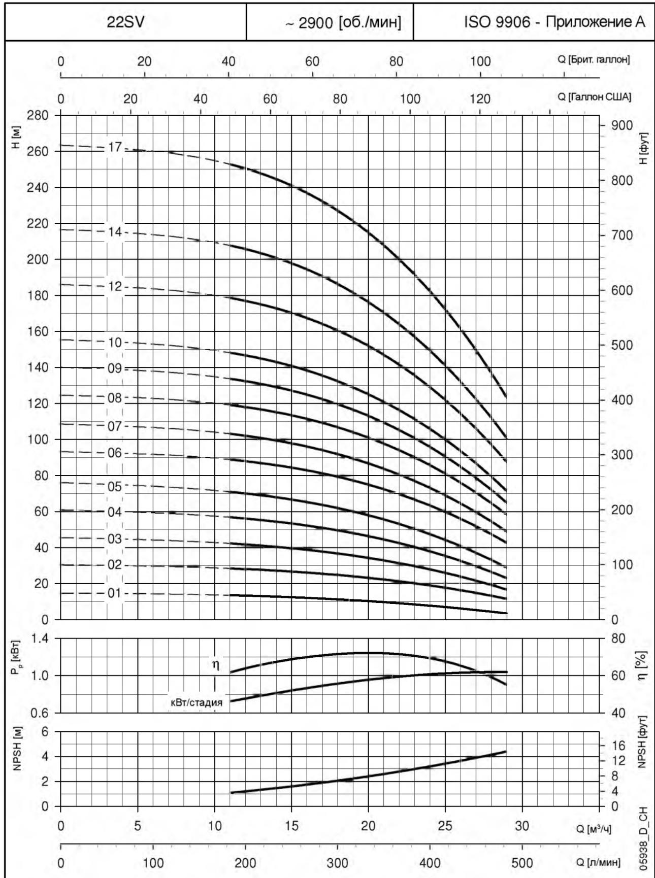
Эти характеристики соответствуют жидкостям с плотностью  $\rho = 1 \text{ кг/дм}^3$  и кинематической вязкостью  $\nu = 1 \text{ мм}^2/\text{сек}$
