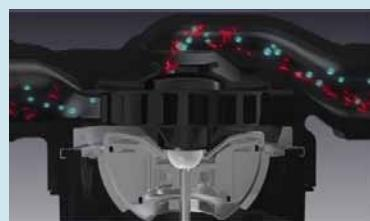
Главный поток перекачиваемой жидкости (синий) и находящиеся в нем частицы магнетита (красные) поддерживаются за пределами магнитной зоны, создаваемой ротором.
